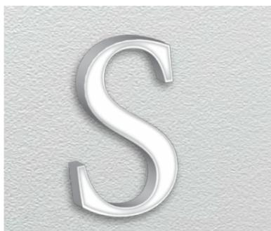
Der nach vorne leuchtende Profilbuchstaben S4 besteht aus einem Metallgehäuse und einer Acrylglasscheibe an der Vorderseite. Das Acrylglas ist durch ein Haltewinkelprofil, das mit der Zarge verschraubt ist, fest im Gehäuse verankert. Das Gehäuse ist in allen RAL-Farben lackierbar. Die Beleuchtung erfolgt durch LEDs.
